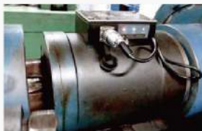
진동 운동에 대한 시험 장치 힘 615kN
